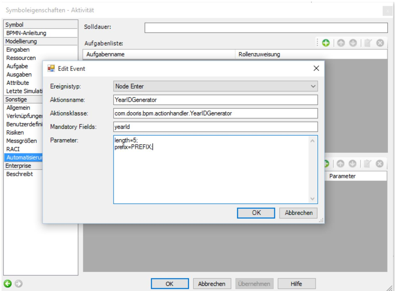
Fünfstellige ID wird erzeugt. Der Instanzname setzt sich nun aus dem vergebenen Instanznamen, dem Prefix sowie der ID zusammen. Die ID wird in der Prozessvariable yearId gespeichert. Die Prozessinstanz in diesem Beispiel heisst nun „Instanzname PREFIX 201400005“.
