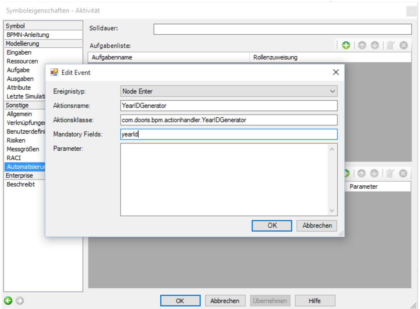
Vierstellige ID wird erzeugt und an Instanznamen angehängt. Die ID wird in der Prozessvariable yearId gespeichert.
