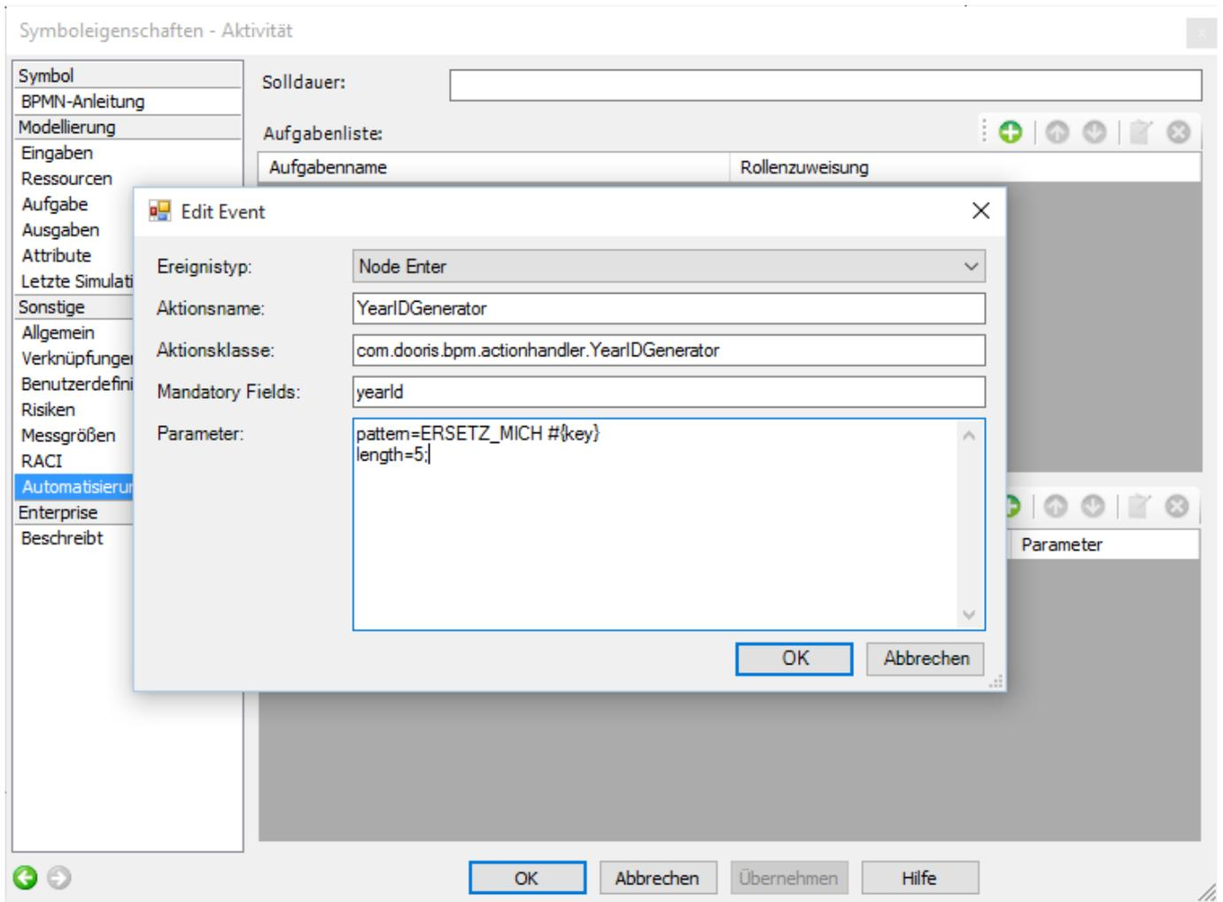
**Fünfstellige ID** wird erzeugt und das Pattern als Instanzname festgelegt. Die ID wird in der Prozessvariable yearId gespeichert. Die Prozessinstanz in diesem Beispiel heisst nun „ERSETZ MICH 201400004“.
