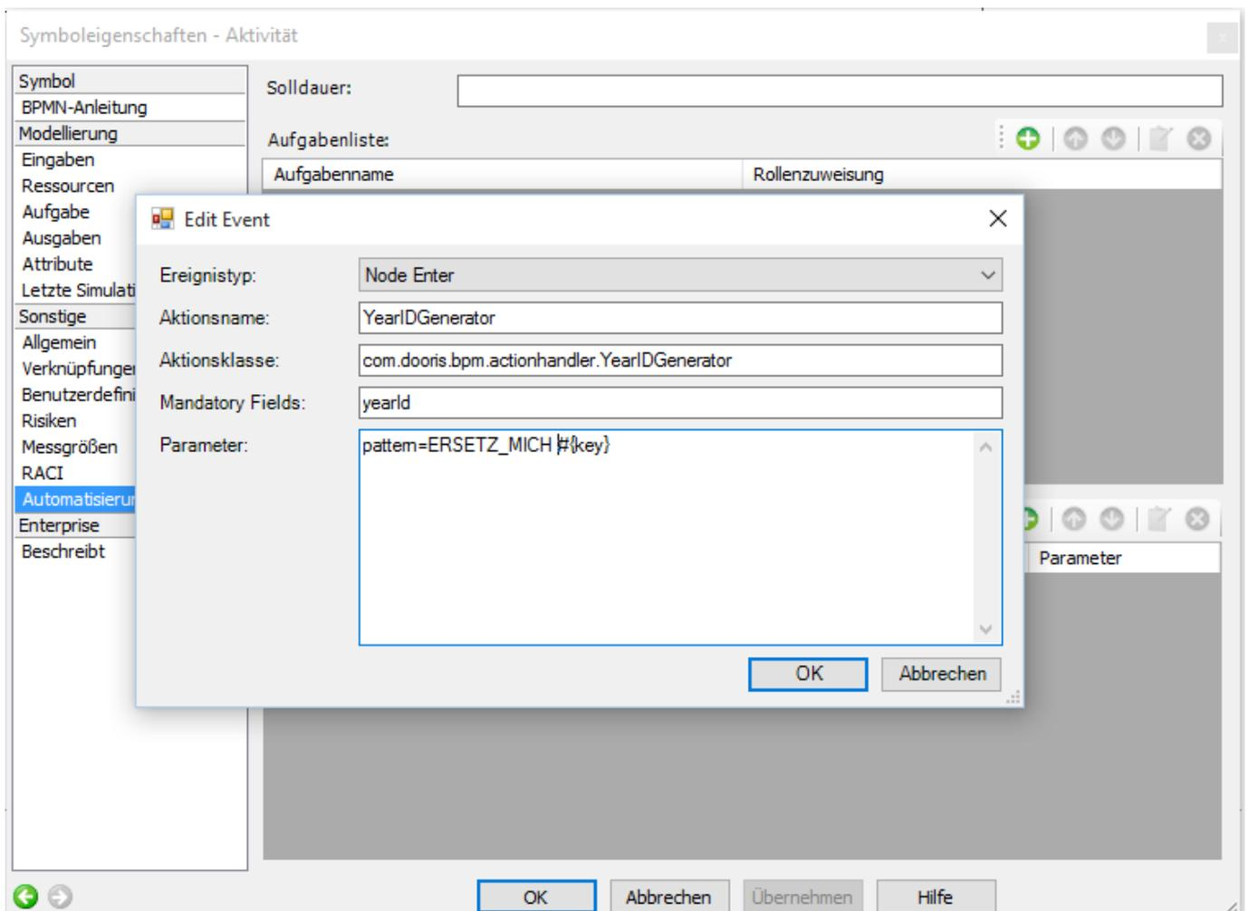
Vierstellige ID wird erzeugt und das Pattern als Instanzname festgelegt. Die ID wird in der Prozessvariable yearId gespeichert. Die Prozessinstanz in diesem Beispiel heisst nun „ERSETZ MICH 20140003“.
