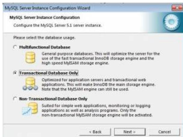
Sollte die Datenbank für keine Anwendungen mehr benötigt werden, kann der Punkt **Transactional Database Only** gewählt werden und mit „Next“ fortfahren. Im nächsten Punkt, kann der Pfad und das Laufwerk der Daten, die MySQL anlegt, angepasst werden.
