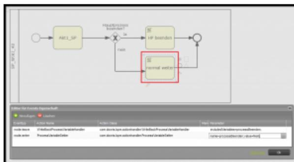
**Im Hauptprozess** wird, unmittelbar auf den Subprozess folgend, eine XOR-Entscheidung benötigt, um die vom Subprozess übergebene Variable zu übernehmen. Abhängig vom Wert der Variable wird hier nun entschieden ob der Prozess beendet oder weitergeführt wird.
