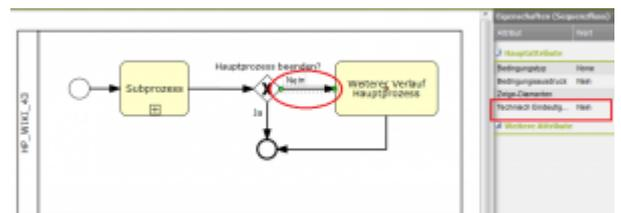
Bei der Transition, die den Hauptprozess beendet, wird der Technisch eindeutige Name auf „Nein“ gesetzt.
