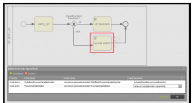
2. Auf Node-Leave wird die gesetzte Variable mit dem [WriteBackProcessVariableHandler](#) an den Hauptprozess übergeben. Auf der direkt darauffolgenden XOR-Entscheidung im Hauptprozess wird die übergebene Prozessvariable überprüft und entschieden, ob der Prozess beendet oder weitergeführt wird.
