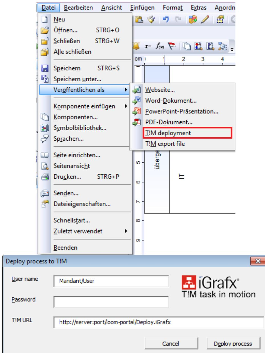
Nach der Eingabe des Benutzernamens und des Passwortes, wird der Prozess durch Anklicken des Buttons „Deploy Process“ veröffentlicht. In der Aufgabekonzole von iGrafX wird eine Meldung über den Erfolg des Deployments angezeigt.
