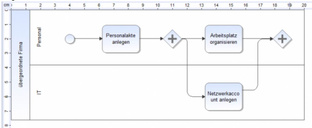
2. Nun muss hinter das schließende AND Element ein XOR Element eingefügt werden. Damit eindeutig ist welche Entscheidung getroffen werden muss, kann dieses Element nun beschriftet werden (z.B. Hardware nötig?). Und anschließend lassen wir den Prozess beenden.
