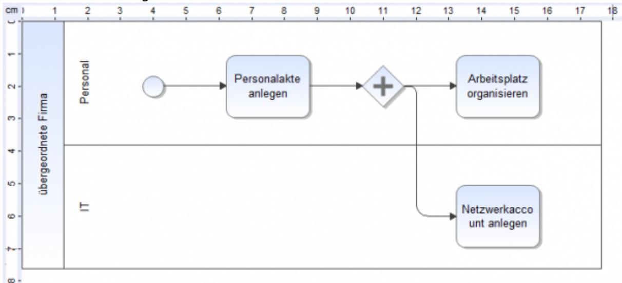
3. Geöffnete UND Verknüpfungen müssen am Ende wieder geschlossen werden, damit der Prozess zur nächsten folgenden Aktivität laufen kann. Dafür muss erneut ein UND in das Diagramm eingefügt werden an der Stelle, an der die Parallele Verzweigung aufhören soll.
